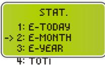
Diese Schnittstelle zeigt die Betriebsstatistik des Wechselrichters an.
