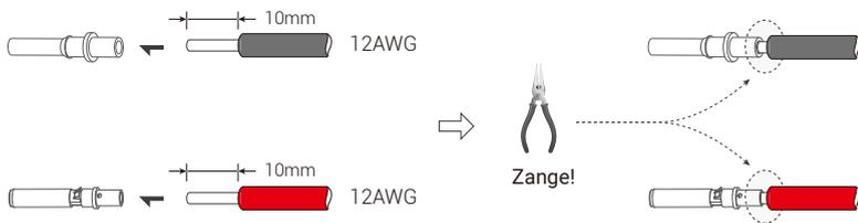
**Schritt 4:** Der Stiftkontakt wird durch die Mutter in den Stecker oder die Buchse eingeführt. Der Stiftkontakt sitzt richtig, wenn Sie ein "Klicken" spüren oder hören. Dann die Mutter festziehen.
